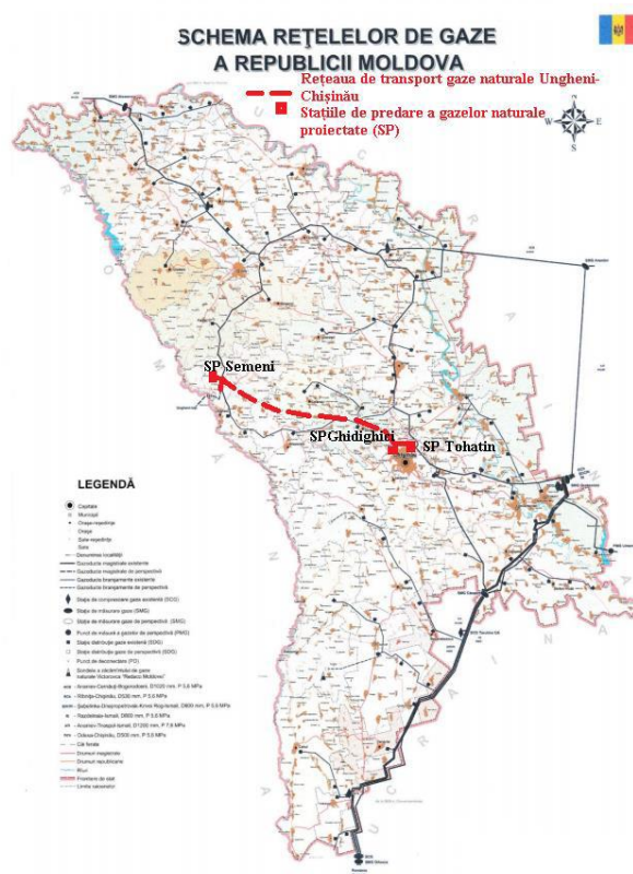
Figura 16- Schema rețelelor de gaze a Republicii Moldova cu extinderea interconectorului Iași-Ungheni-Chișinău (Faza II)
